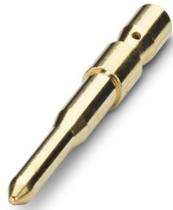
Crimpkontakt, Stift, gedreht, Kontaktdurchmesser: 1,5 mm, Crimpbereich: 0,08 mm<sup>2</sup> ... 0,56 mm<sup>2</sup>, Artikel ist bleifrei nach RoHS II ohne Ausnahme 6c (Pb < 0,1 %)
