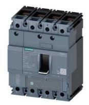
Leistungsschalter 3VA1 IEC Frame 160 Schaltvermögenklasse M Icu=55kA @ 415V 4-polig, Anlagenschutz TM220, ATFM, In=20A Überlastschutz Ir=14A...20A Kurzschlussschutz Ii=16 x In N-Leiterschutz 100% Schraubenflachanschluss
