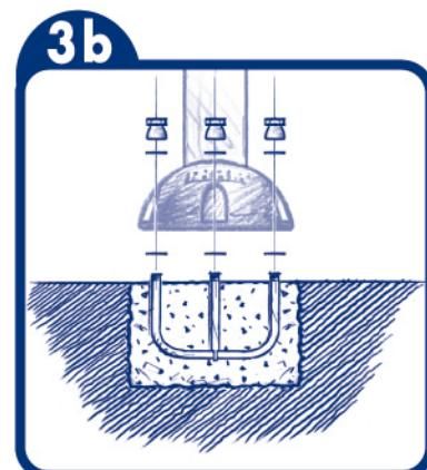
Fissaggio standard - Fixation standard
