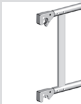
Doppelgeländer 2,85 m aus Aluminium. Länge 2,85 m, Höhe 0,5 m, Gewicht 8,0 kg.
