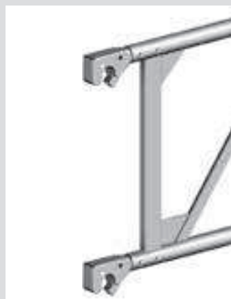
Träger 1,80 m aus Aluminium. Tragelemente im Gerüstbaukasten oder doppelter Seitenschutz. Höhe 0,5 m, Gewicht 7,7 kg.
