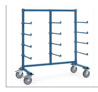
Ensemble mécano-soudé, revêtement époxy bleu RAL 5007. Système modulable pour éléments longs et stockage. Chariot complètement boulonné, barres réglables en hauteur. 1 face avec 12 barres de portée habillées d'un tube de PVC de 3 mm d'épaisseur et avec butée de sécurité. Longueur utile : 600 mm. 2 roues fixes et 2 roues pivotantes à bandage TPE, moyeu à roulement à billes. Freins sur roues pivotantes conformément à la Norme EN 1757-3. Charge par étage : 80 kg.
