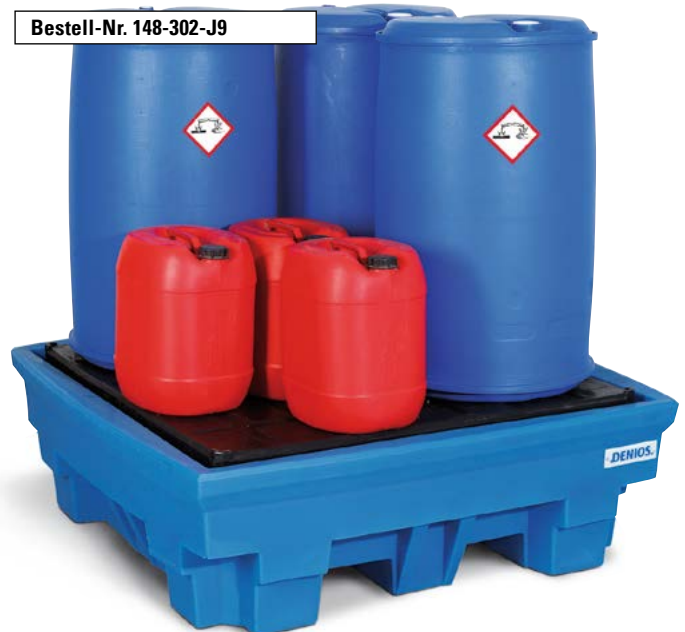
Typ PolySafe Premium PP 4-200, für bis zu 4 Fässer à 200 Liter, ideal zum Abfüllen von u. a. Säuren und Laugen, Auffangvolumen 450 Liter
