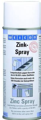
WEICON Zink-Spray verleiht dauerhaft allen Metalloberflächen, wie z.B. nachzubessernden feuerverzinkten Teilen, kathodischen Korrosionsschutz. Es bildet eine schnelltrocknende, festhaftende Schutzschicht aus mikrofeinen Zinkflakes.
