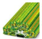
Doppelstockklemme, Anzahl der Anschlüsse: 8, Anschlüssart: Push-in-Anschlüss, 1. und 2. Etage, Bemessungsquerschnitt: 2,5 mm², Querschnitt: 0,14 mm² - 4 mm², Montageart: NS 35/7,5, NS 35/15, Farbe: grün-gelb
