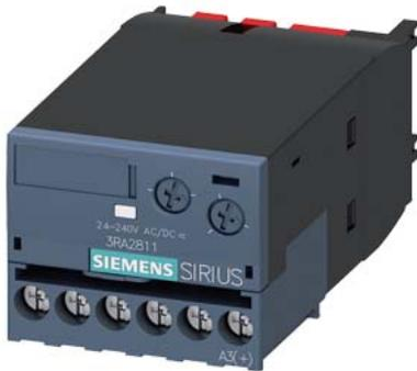
Elektronisches Zeitrelais, ansprechverzögert, mit Halbleiterausgang, Zeitbereich 0,05-100 s, AC/DC 24-240 V, 50/60 Hz, Varistor zur Bedämpfung der Schützspulen integriert, Schraubanschluss, frontseitig aufschraubbar auf Schütze 3RT2.1 / 3RT2.2 und Hilfsschütze 3RH2
