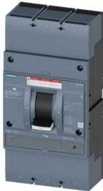
Leistungsschalter 3VA5 UL Frame 800 Max. Kurzschl-Ausschaltvermögen ohne Schütz 65 kA@480 V 3-polig, Starterschutz TM120M, AM, In=800A ohne Überlastschutz Kurzschlusschutz li=6...12 x In beidseitig Kabelanschluss
