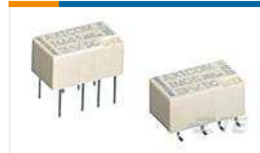
TE Teilnr.:2-1462038-4 IM46NS=IM RELAY 100mW 12V BIS
