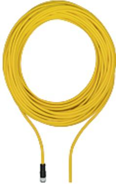
Anschlusskabel, PUR, Gelb RAL1003, Schleppkettenfähig, 8-polig, Buchse gerade M12, auf offenes Leitungsende, A-kodiert, Kabellänge: 20 m
