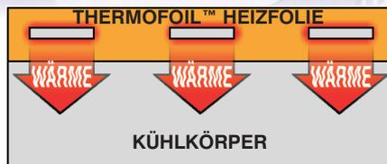
Eine korrekte Installation bietet Gewähr für einen guten Wärmefluss vom Heizer
