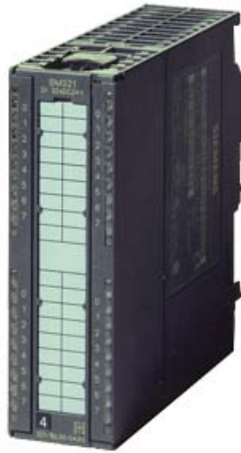
SIMATIC S7-300, DIGITALEINGABE SM 321, POTENTIALGETRENNT 32DE, DC 24V , 1 X 40-POLIG
