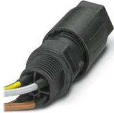
Wanddurchführung, QUICKON-Anschluss, Polzahl: 3+PE, 1 mm<sup>2</sup> ... 2,5 mm<sup>2</sup>, 690 V, 20 A, schwarz, mit QUICKON-Mutter, Leitungsaußendurchmesser: 6 mm ... 10 mm, Montagegewinde: M25, IDC-Anschluss (angeschweißt), 2,5 mm<sup>2</sup>, Adern glatt abgeschnitten, Leitungslänge: 1 m
