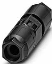
Leitungsverbinder, QUICKON-Anschluss, Polzahl: 3+PE, 1 mm<sup>2</sup> ... 2,5 mm<sup>2</sup>, 690 V, 20 A, schwarz, mit zwei QUICKON-Muttern, Leitungsaußendurchmesser: 6 mm ... 10 mm, QUICKON-Schnellanschluss
