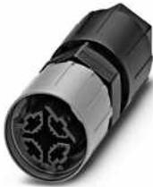
Steckverbinder, QUICKON-Anschluss, Polzahl: 3+PE, 1 mm<sup>2</sup> ... 2,5 mm<sup>2</sup>, 690 V, 20 A, schwarz, mit QUICKON-Mutter, Leitungsaußendurchmesser: 6 mm ... 10 mm
