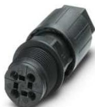
Wanddurchführung, QUICKON-Anschluss, Polzahl: 3+PE, 1 mm<sup>2</sup> ... 2,5 mm<sup>2</sup>, 400 V, 20 A, schwarz, mit QUICKON-Mutter, Leitungsaußendurchmesser: 6 mm ... 10 mm, Montagegewinde: M25, Push-in-Anschluss, 2,5 mm<sup>2</sup>
