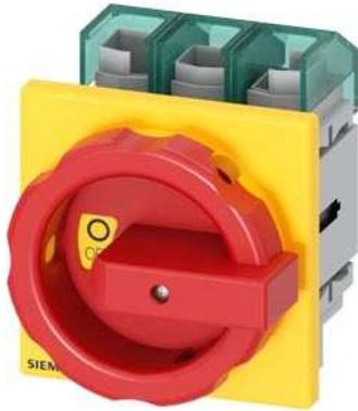
SETRON, Lasttrennschalter 3LD5 UL, Not-Aus-Schalter, 3-polig, approbiert nach UL489, UL60947-4-1 und IEC60947-3, UL: 60A, SCCR 50kA at 480VAC, Betriebsleistung @ 480VAC 3-phasig: 40hp, IEC: 63A, Betriebsleistung bei AC-23A bei 400V: 30kW, Frontbefestigt, Drehantrieb, rot/gelb, 4-Loch Befestigung der Handhabe, inklusive Klemmenabdeckungen für die Einspeiseseite
