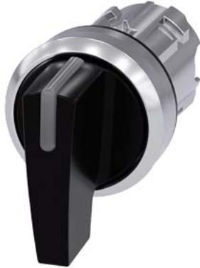
Knebelschalter beleuchtbar, 22 mm, rund, Metall hochglanz, schwarz, Knebel lang, 3 Schaltstellungen I>O-II, links tastend, rechts verrastend, Schaltwinkel 2x45°, 10:30h/12h/13:30h
