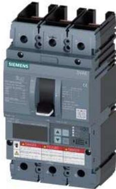
Leistungsschalter 3VA6 UL Frame 150 Schaltvermögenklasse M 35kA @ 480V 3-polig, Anlagenschutz ETU850, LSI, In=40A Überlastschutz Ir=16A...40A Kurzschlusschutz I<sub>sd</sub>=0,6..10x I<sub>n</sub>, I<sub>i</sub>=1,5..12x I<sub>n</sub> N-Leiterschutz optional mit externem Stromwandler, bis 160% ohne Anschluss
