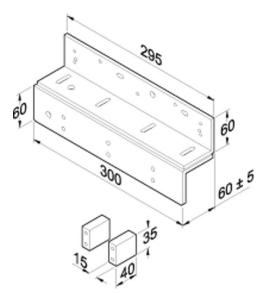
Für die Montage der Flächenhaftmagneten 827A und 827HA an flächenbündigen Türelementen.
