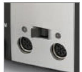
Anschlüsse für zwei Lötwerkzeuge
