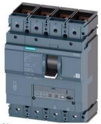
LEISTUNGSSCHALTER 3VA2 IEC FRAME 630 SCHALTVERMOEGENKLASSE H ICU=85KA @ 415 V 4-POLIG, ANLAGENSCHUTZ ETU330, LIG, IN=400A UEBERLASTSCHUTZ IR=160A ...400A KURZSCHLUSSSCHUTZ II=1,5...12 X IN N-LEITERSCHUTZ EINSTELLBAR (OFF,50%,100%) ERDSCHLUSSSCHUTZ IG=0,2... 1 X IN, TG=0,1/0,3MS SCHRAUBENFLACHANSCHLUSS
