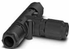
QUICKON T-Verteiler, schwarz, 4+PE-polig, 2,5 mm<sup>2</sup> ... 6,0 mm<sup>2</sup> / 690 V / 40 A, für Kabeldurchmesser 9 mm ... 14 mm, mit drei Quickon-Muttern
