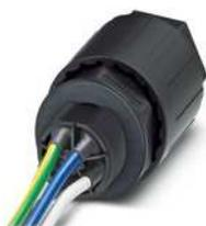
QUICKON-Wanddurchführung, 4+PE-polig, 2,5 mm<sup>2</sup>... 6,0 mm<sup>2</sup> / 690 V / 40 A, mit QUICKON-Mutter, schwarz, für Kabeldurchmesser 9 mm ... 14 mm, M25-Anschlussgewinde mit 5 angeschweißten 6,0 mm<sup>2</sup> Leitungsadern, 1,0 m lang, am Ende glatt abgeschnitten.
