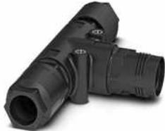
QUICKON T-Verteiler, schwarz, 4+PE-polig, 2,5 mm<sup>2</sup> ... 6,0 mm<sup>2</sup> / 690 V / 40 A, für Kabeldurchmesser 9 mm ... 14 mm, mit zwei Quickon-Muttern
