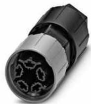
Steckverbinder, IDC-Anschluss, Polzahl: 4+PE, 2,5 mm<sup>2</sup> ... 6 mm<sup>2</sup>, 690 V, 40 A, schwarz, mit QUICKON-Mutter, Leitungsaußendurchmesser: 9 mm ... 14 mm
