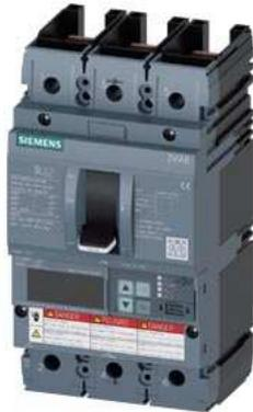
Leistungsschalter 3VA6 UL Frame 150 Schaltvermögenklasse M 35kA @ 480V 3-polig, Anlagenschutz ETU860, LSIG, In=150A Überlastschutz, 100% rated Ir=60A...150A Kurzschlusschutz Isd=0,6..10x In, li=1,5..10x In N-Leiterschutz optional mit externem Stromwandler, bis 160% Erdschlusschutz Ig=0,2...1 x In, tg=0,05-0,8s ohne Anschluss
