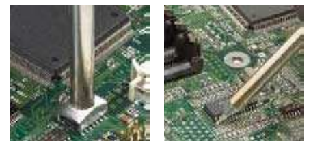
Die schlanken Lötpatronen ermöglichen einen leichten Zugang zu den Lötstellen. Für alle SMD-Reworkarbeiten sind geeignete Lötpatronen verfügbar.
