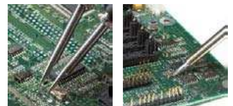
Die Präzisionspinzette eignet sich für das Rework von SMD-Bauelementen - vom kleinsten Chip-Bauteil bis zu großen SOICs. Der Lötspitzen-Lötgriffel bietet Leistungsreserven für das Produktionslöten.
