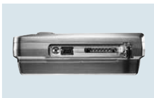
Seitlicher Anschluss von Mini-USB-Kabel und SD-Karte
