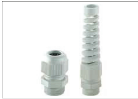
BF / MBF / BFK / MBFK: – Pg/Metrisch – IP 68, 5 bar (30 min.) / DIN EN 60529 – Polyamid lichtgrau, ähnlich RAL 7035 – Integrierte Zugentlastung – Temperaturbereich: -20 °C bis +100 °C – VDE-Ausweis (nur MBF): Nr. 134176 – Integrierter Knickschutz (BFK/MBFK)
