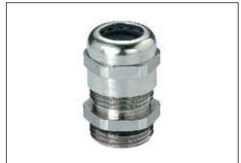
MEMV: – Metrisch – IP 68, 5 bar (30 min.) / DIN EN 60529 – Messing vernickelt – Integrierte Zugentlastung – Verdrehschutz – Temperaturbereich: -20 °C bis +100 °C – Für Leitungen mit Schirmung – Schnelle und einfache EMV-Verbindung des Schirmgeflechts über die Kontaktfeder und den Zwischenstutzen mit dem Gehäusepotential – Der Schutzschirm wird unter formschlüssigen Druck dauerhaft und großflächig mit dem Gehäuse verbunden
