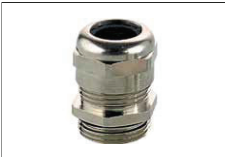
MSBF: – Metrisch – IP 68, 5 bar (30 min.) / DIN EN 60529 – Messing vernickelt – Integrierte Zugentlastung – Verdrehschutz – Temperaturbereich: -20 °C bis +100 °C
