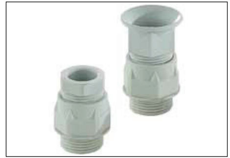
POZ / MPOZ / POZB / MPOZB: – Pg/Metrisch – IP 65 / DIN EN 60529 – Polyamid lichtgrau, ähnlich RAL 7035 – Integrierte Zugentlastung – Temperaturbereich: -30 °C bis +100 °C – Integrierter Knickschutz (POZB/MPOZB)
