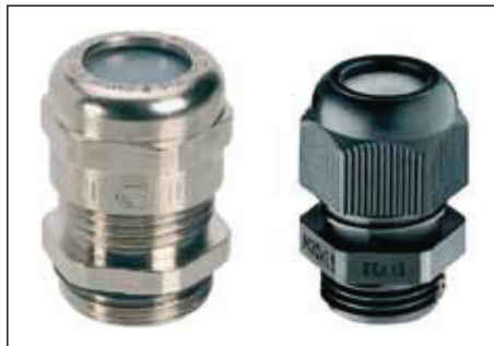
M-EX..PA: – Metrisch – IP 66 / DIN EN 60529 – Polyamid schwarz, ähnlich RAL 9005 – Integrierte Zugentlastung – Temperaturbereich : -30 °C bis +70 °C – Prüfnorm: EN 50014/EN50019/EN50020 – EG-Prüfbescheinigungen: PTB 99 ATEX 3101 x (M12,M16), PTB 99 ATEX 3128 x (ab M 20)
