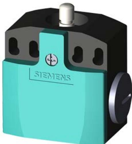
SIRIUS POSITIONSSCHALTER, KUNSTSTOFF 50MM, ERHOEHETER KORROSIONSSCHUTZ, GERAETEANSCHLUSS 2X (M20X1,5) 1S/ 10E SCHLEICHKONTAKTE KUPPENSTOESSEL, FUNKTIONSFAEHIG BEI -40 GRAD, SCHOCK-UND SCHWINGPRUEFUNG NACH EN61373, KATEGORIE 1B
