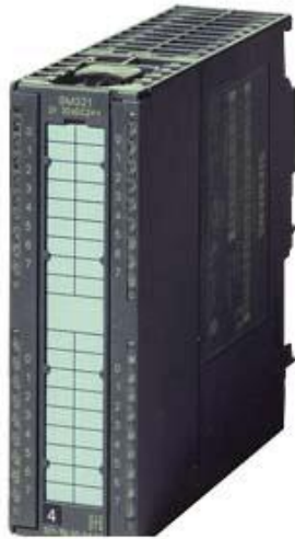
SIMATIC S7-300, DIGITALEINGABE SM 321, POTENTIALGETRENNT 16DE, DC 24V, M-LESEND, 1 X 20-POLIG
