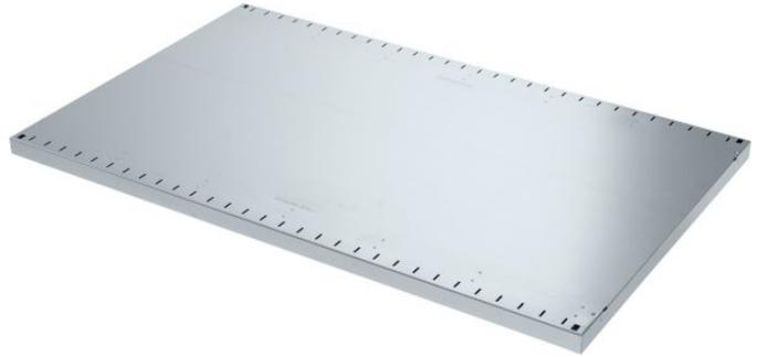
Die maximale Traglast pro Fachboden beträgt je nach lichter Rahmentiefe zwischen 100 und 250 kg. Diese Belastungswerte gelten jedoch nur in Kombination mit Längstraversen. Bei der lichten Rahmentiefe der Fachböden WR 3000 haben Sie die Wahl zwischen 400, 500, 600 oder 800 mm.
