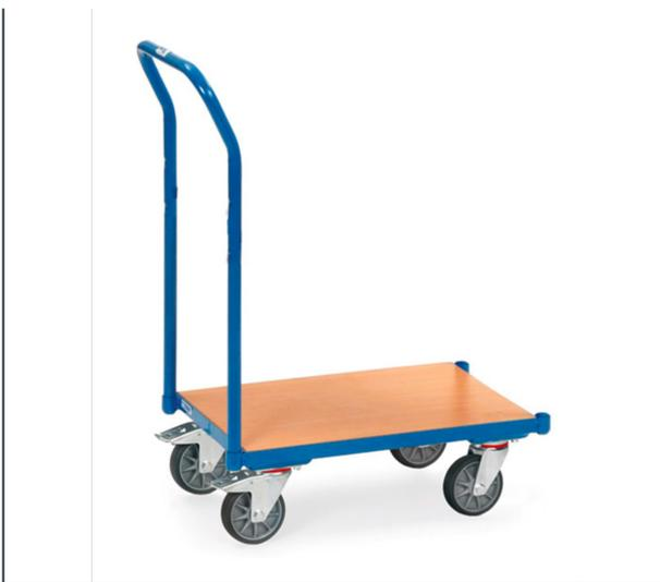
Winkelstahlkonstruktion mit mit Holzplattform bündig mit Rahmen und Schiebebügel. Pulverbeschichtet blau RAL 5007. 4 Lenkrollen mit TPE-Bereifung, Naben mit Rillenkugellager. 2 Stück mit Feststeller, gemäß der Europäischen Norm EN 1757-3 (Sicherheit von Plattformwagen). Passend für Eurokästen 600 x 400 mm.
