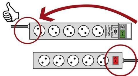
Image d'utilisation, entrée du câble du côté opposé à l'interrupteur
