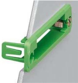
Anbaurahmen, Nennquerschnitt: 2,5 mm<sup>2</sup>, Farbe: grün, Anzahl der Potenziale: 10, Anzahl der Reihen: 1, Polzahl: 10, Anzahl der Anschlüsse: 10, Artikelfamilie: IC-DFR, Rastermaß: 5,08 mm, Verpackungsart: verpackt im Karton, Dieser Montagerahmen ist nur in Kombination mit IC 2,5/...-STGF-5,08 zu verwenden
