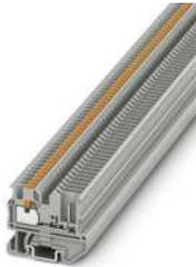
Minidurchgangsklemme, Strom und Spannung werden durch den eingesetzten Stecker bestimmt., Nennspannung: 500 V, Nennstrom: 17,5 A, Anschlussart: Push-in-Anschluss, 1. Etage, Bemessungsquerschnitt: 1,5 mm<sup>2</sup>, Querschnitt: 0,14 mm<sup>2</sup> - 1,5 mm<sup>2</sup>, Montageart: NS 15, Farbe: grau
