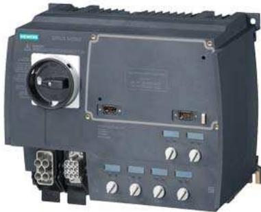
SIRIUS Motorstarter M200D Technologiemodul Reversierstarter elektronisch schaltend AC-3, 5,5 kW / 400 V 1,5 A...12,00 A elektronischer Überlastschutz Thermistor: THERMOCLICK / PTC mit Bremskontakt 400 V AC 4DI / 2DO Han Q4/2 - Han Q8/0 mittels Kommunikationsmodul 3RK1305\* verwendbar an PROFIBUS oder PROFINET
