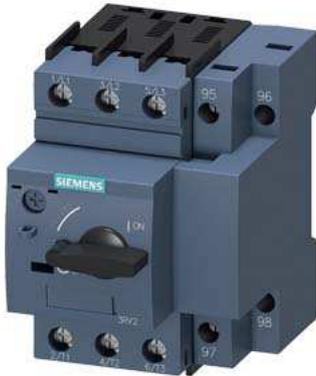
Leistungsschalter Baugröße S00 für den Motorschutz, CLASS 10 mit Überlast-Relaisfunktion A-Auslöser 0,45...0,63 A N-Auslöser 8,2 A Schraubanschluss Standardschaltvermögen
