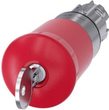
NOT-HALT-Pilzdrucktaster, 22 mm, rund, Metall, hochglanz, rot, 40 mm, mit Schloss Siemens, Schließ-Nr. SSP9, zwangsläufige Verrastung, gemäß DIN EN ISO 13850, Schlossentriegelung
