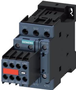
Leistungsschütz, AC-3 38 A, 18,5 kW / 400 V 2 S + 2 Ö, DC 24 V mit eingesteckter Dioden- kombination, 3-polig Baugröße S0, Schraubanschluss Hilfsschalter nicht lösbar
