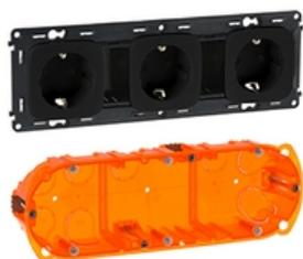
Valena Allure 3-fach vorverdrahtete Doppel-Schutzkontakt-Steckdose 16A inklusive Abdeckung , mit erhöhtem Berührungsschutz (Kindersicherung) und schraublosen Anschlussklemmen, inkl. Installationsdose für Hohlwand- und Unterputzmontage im Lieferumfang, Farbe: Schwarz
