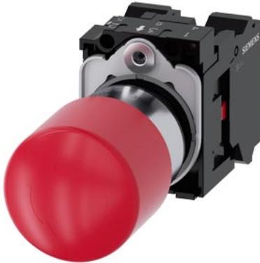
NOT-HALT-Pilzdrucktaster, 22 mm, rund, Metall, hochglanz, rot, 30 mm, zwangsläufige Verrastung, gemäß DIN EN ISO 13850, Drehentriegelung, Unterlegscheibe für NOT-HALT, gelb, 60mm, ohne Beschriftung, mit Halter, 1Ö, 1Ö, Federzuganschluss, Frontplattenbefestigung
