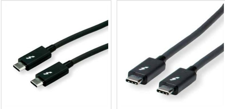
**Les câbles Thunderbolt 3 avec le connecteur USB 3.1 de type C vous offrent le taux de transfert de données actuellement le plus élevé possible jusqu'à 40Gbit/s (20Gbit/s à partir de 1m) et la prise en charge complète de la puissance (PD jusqu'à 20V 5A / 100W) ! Les câbles sont également équipés du mode DP pour la transmission d'images et de sons jusqu'à 5120x2880 @60Hz (5K).**
