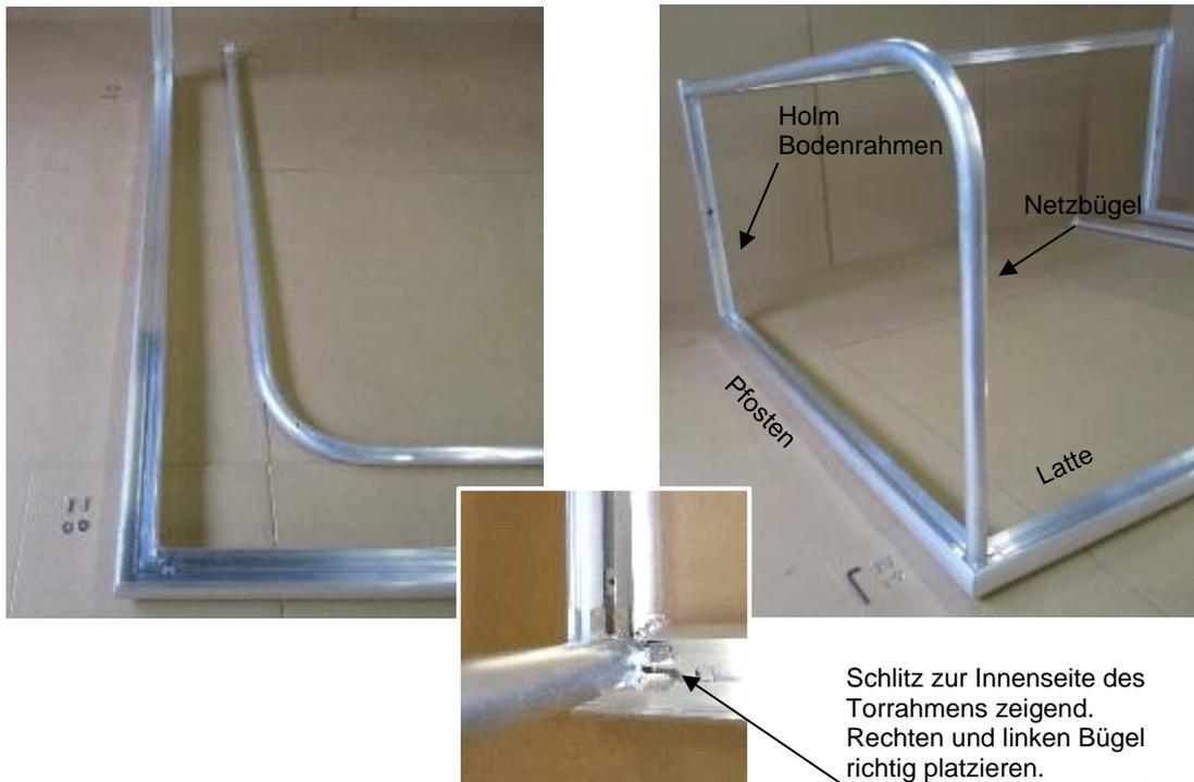
Befestigung Netzbügel oben: Im Eckbereich Latte/Pfosten die werkseitig und zuvor bei der Montage im Pfosten eingeschobenen Einsteckmuttern unter die geschlitzte Platte des Netzbügels schieben (siehe Foto unten links). 2 Stck. Unterlegscheiben DIN 9021, Ø 7,4 mm auf 2 Stck. Zylinderschrauben DIN 912, M6 x 20 aufstecken und den Netzbügel mit den Zylinderschrauben an den Einsteckmuttern befestigen (siehe Foto unten rechts und Mitte).
