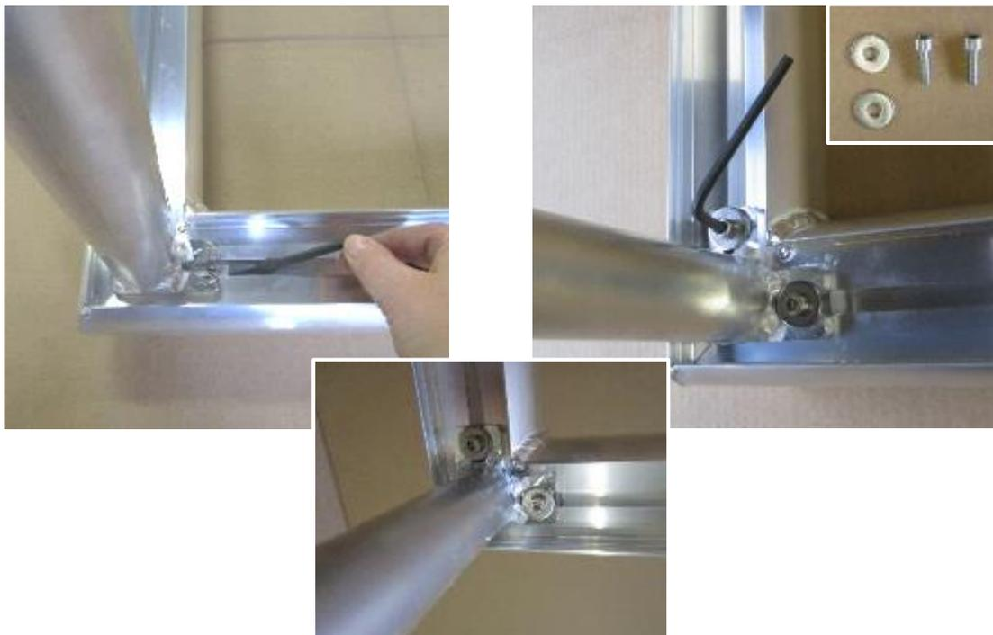
Befestigung Netzbügel unten: Für diesen Montageschritt zunächst das Tor aufrichten (siehe Foto unten links). An der Bodenrahmenecke die werkseitig eingeschobene Einsteckmutter unter die geschlitzte Platte des Netzbügels schieben. 1 Stck. Unterlegscheibe DIN 9021, Ø 7,4 mm auf 1 Stck. Zylinderschraube DIN 912, M6 x 20 aufstecken. Die Zylinderschraube zur Netzbügel-fixierung in die Einsteckmutter lose einschrauben (siehe Foto unten rechts).
