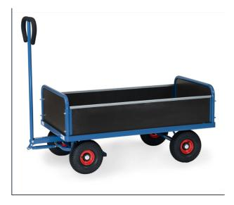
En tube d'acier soudé, revêtement époxy bleu RAL 5007. Avec 2 ridelles sur petit côté hauteur 300 mm et 2 sur grand côté amovibles hauteur 220 mm, avec plateau en contreplaqué. Essieu avec timon et poignée. Roues gonflables, moyeu à roulement à rouleaux. Poignée sécurisée avec revêtement souple remontant automatiquement en position verticale. Blocage automatique de l'essieu avant, conformément à la Norme EN 1757-3.
