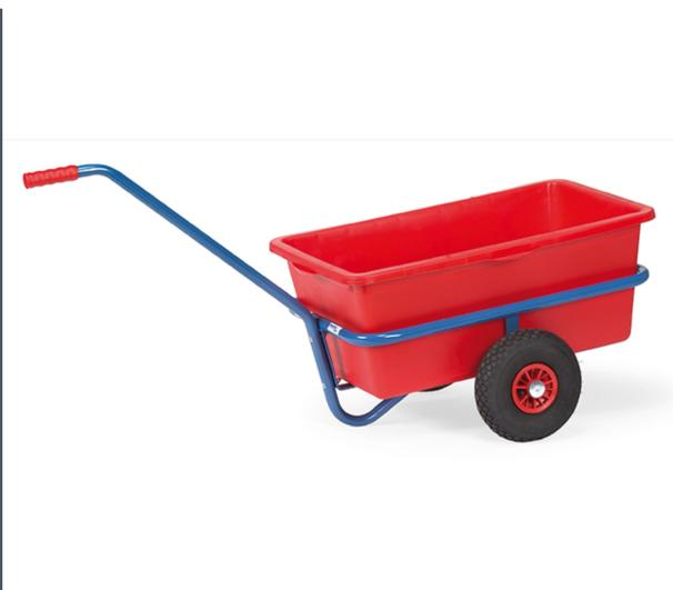
Char à bras léger en tube et profilé d'acier soudés, revêtement époxy bleu RAL 5007. Timon à boulonner. Avec cuvette rouge contenance 90 litres. Roues gonflables, moyeu à roulement à rouleaux. Livré non monté, montage facile.
