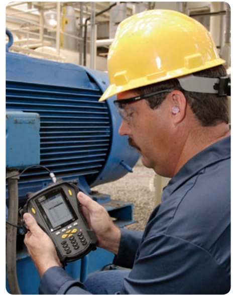
Schwingungsmessung mit Hilfe des SKF Microlog Datensammlers/-analysators
