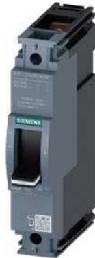
Leistungsschalter 3VA1 IEC Frame 160 Schaltvermögenklasse S Icu=36kA @ 240V 1-polig, Anlagenschutz TM210, FTFM, In=63A Überlastschutz Ir=63A fest eingestellt Kurzschlusschutz li=10 x In Schraubenflächanschluss
