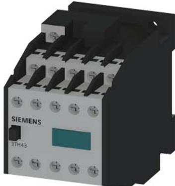
Hilfsschütz, 64E, DIN EN 50011, 6 NO + 4 NC, Schraubanschluss, AC-Betätigung, AC 110V 50Hz/AC 132V 60Hz
