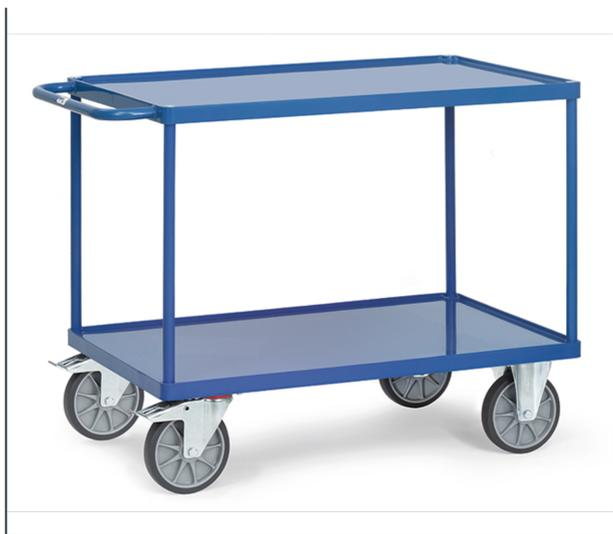
Système modulaire : ensemble mécano-soudé, revêtement époxy RAL 5007, assemblé selon le principe des "inserts fetra". Plateau en tôle d'acier soudé avec rebord de 10 mm de haut. 2 roues pivotantes et 2 fixes à bandage TPE, moyeu à roulement à billes central. Freins sur roues pivotantes conformément à la Norme Européenne EN 1757-3 (Sécurité des chariots de manutention). Charge maximum plateau du haut : 200 kg.
