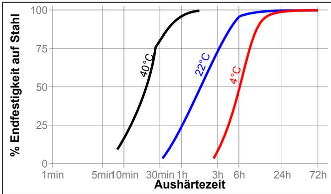
**Aushärtegeschwindigkeit in Abhängigkeit vom Aktivator**
