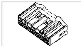
Steckverbinder- und Gehäusotyp: **Buchsengehäuse**
