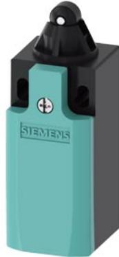
Positionsschalter Kunststoffgehäuse nach DIN EN 50047, 31 mm Geräteanschluss 1 x (M20 x 1,5) 1S/1Ö Sprungkontakte integriert (nicht austauschbar) Rollenstößel, Form C mit Kunststoffrolle 10 mm
